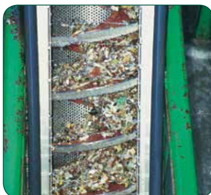
Шнек поднимает измельченные предметы
