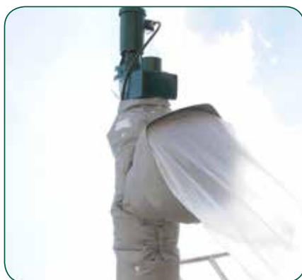
Auger с теплоизоляционным слоем и мешком для выгрузки
