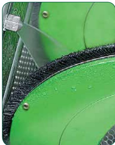
Заменяемая щетка шнека сохраняет перфорированный барабан чистым и помогает транспортировать твердые вещества.
