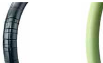
Уплотнительные кольца из нитрила (слева) и Витона после испытания при 200° C.
