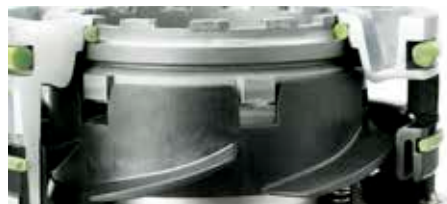
Пропеллер охлаждающего насоса.
