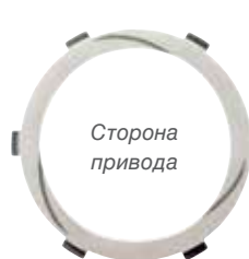
Перекачивание обеспечивается канавками, вырезанными лазером на поверхности трения.
