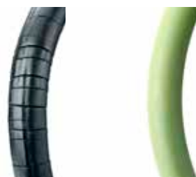
Уплотнительные кольца из нитрила (слева) и витона после испытания при температуре 200° C.
