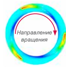
По канавкам жидкость непрерывно перекачивается с внутреннего диаметра на внешний диаметр поверхности трения.
