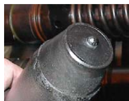
Форсунка большого дизельного двигателя, заблокированная в результате загрязнения топлива
